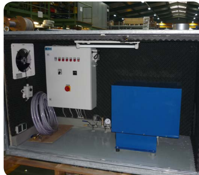
Betongeräteschrank mit Kolbenkompressor 3,0 KW inkl. Kompressorsteuerung
